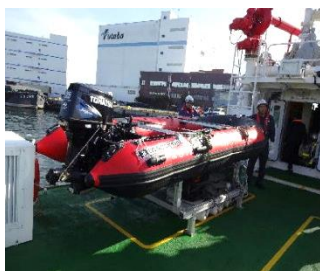
穴が開いても沈まない、 ウレタン注入小型救助艇
